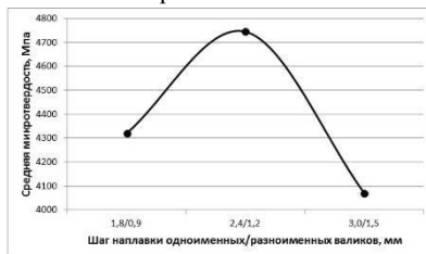
Рис. 6. Зависимость средней микротвердости фазы бронзы ПГ-19М-01 от шага наплавки
