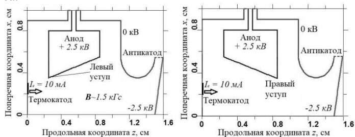
Рис. 1. Модели ионного источника Пеннинга в KARAT.
