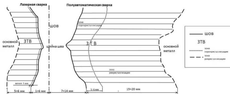
Рис. 1. Сравнение структур сварных соединений сплава на основе Al-Zn-Mg, полученных ЛС и ПС.
